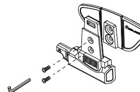
**Paso 2.** Apriete la lámina con mordaza con el soporte de montaje usando los dos tornillos suministrados.
