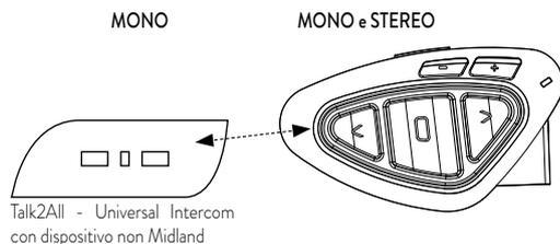
Ad abbinamento concluso la luce rossa/blu smette di lampeggiare. Per aprire o chiudere la comunicazione dal BTX1 PRO verso il dispositivo non Midland premere il pulsante "Avanti" (in Intercom Mode). Sul dispositivo non Midland potete aprire la comunicazione manualmente premendo il tasto per la chiamata telefonica. Potrebbe essere necessario premere il tasto di chiamata due volte, dipende dal modello del dispositivo non Midland.
