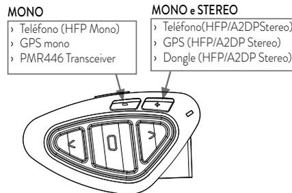
**Atención:** las fuentes de audio A2DP estéreo sólo se pueden enlazar a la tecla Vol+. El segundo teléfono enlazado en la tecla Vol- sólo funcionará en mono (HFP Hands free profile).
