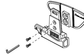
**Step 2.** Vissé à l'aide des deux vis fournit la plaque de serrage au kit de montage à glissière.
