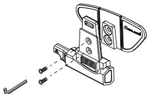
**Schritt 2.** Befestigen Sie die Schraubenplatte mit den zwei mitgelieferten Schrauben an der Slide-In Halterungsdoppelseitigem Klebeband
