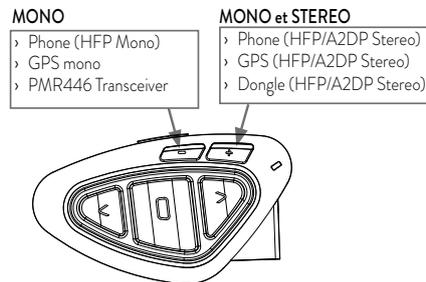
Lorsqu'un appareil est couplé aux boutons « Vol + » ou « Vol - » le mode « Téléphone » est activé.
