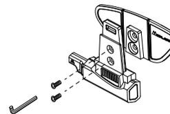
2) Tramite le due viti in dotazione avvitate la base a morsetto alla slitta.
