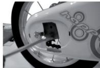
Abb. 3 Die Befestigungsschrauben mit einem 10er-Schlüssel vom Rahmen entfernen.
