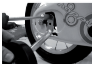
Abb. 4 Den Stabilisator an den beiden Gewindebohrungen des Rahmens anbringen, die obere Schraube der Platte mit einem Anzugsmoment von 10Nm einschrauben. Dieser Vorgang muss auf der rechten wie linken Rahmenseite vorgenommen werden. Die Stabilisatoren müssen immer paarweise mit jeweils zwei Befestigungsschrauben eingebaut werden.
