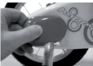
Abb. 7 Das rechte Plättchen der Abdeckkappe in den Schlitz des Kettenschutzes stecken.
