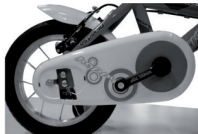
Abb. 2 Kontrollieren, ob die beiden Schrauben des Stabilisators am Rahmen eingeschraubt sind.
