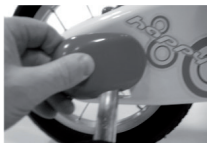
fig. 7 Introduzca la patilla derecha de la tapa dentro de la ranura del cárter protector.
