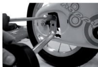
fig. 4 Coloque el estabilizador de manera que coincida con los dos orificios roscados del cuadro, enrosque el tornillo superior de la placa con un par de apriete de 10Nm. Esta operación debe hacerse del lado derecho e izquierdo del cuadro. Los estabilizadores siempre se deben montar en pares, con dos tornillos de fijación cada uno.
