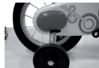
Abb. 9 Mit der Hand prüfen, ob das Ganze gut eingepasst ist und nicht leicht entfernt werden kann, ansonsten die Vorgänge 7 und 8 wiederholen.
