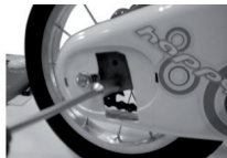
fig. 3 Quite los tornillos de fijación del cuadro con una llave de 10.
