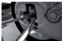
fig. 5 Enrosque también el tornillo inferior con un par de apriete de 10Nm.
