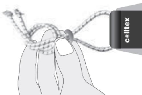
**4.** Fissare le estremità della cinghia elastica nel fermacavo.
