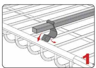
Place the bracket onto the side rail. 將行李盤輔助桿放置在欲安裝的位置。
