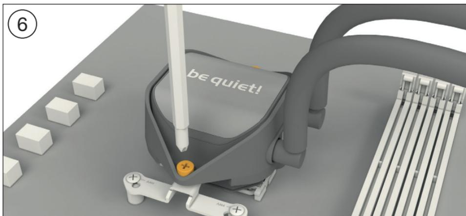
Coloque el bloque de CPU en una posición central sobre los puentes de montaje Intel (4), de forma que permitan desatornillar el bloque de CPU. Para ello, puede usar un destornillador de estrella convencional. A continuación, conecte la bomba y la iluminación LED al adaptador SATA (19).
