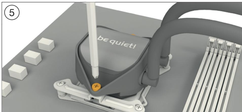
Coloque el bloque de CPU en una posición central sobre los puentes de montaje Intel (4), de forma que permitan desatornillar el bloque de CPU. Para ello, puede usar un destornillador de estrella convencional. A continuación, conecte la bomba y la iluminación LED al adaptador SATA (18).
