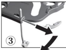
Per rimuovere il laccio dal supporto interno, rimuovere quest'ultimo dal casco. Tirare il laccio fino al suo arresto, quindi piegarlo verso il retro del supporto interno per sbloccarlo ③. Per reinstallarlo, eseguire la procedura di rimozione al contrario.
